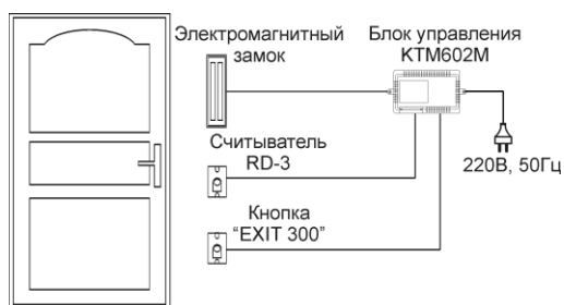
Рисунок 1.4 - Структурная схема контроллера ключей RF VIZIT-KTM602R.
